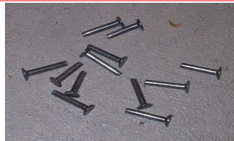
繰り返しの加震で合板を止めていた釘が切れています
